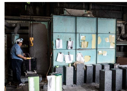
サンドブラストによる墓石の加工様子
